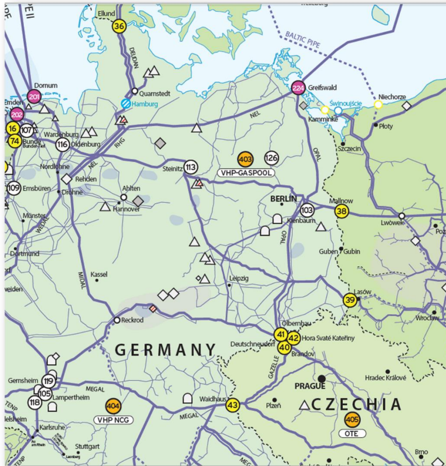
Figure 1: Nord Stream 1, OPAL, and NEL pipelines
